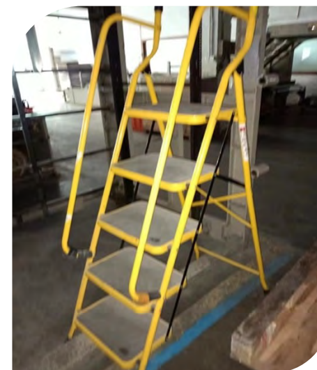
將原本有摔落風險的人字梯更換成雙側手扶梯
