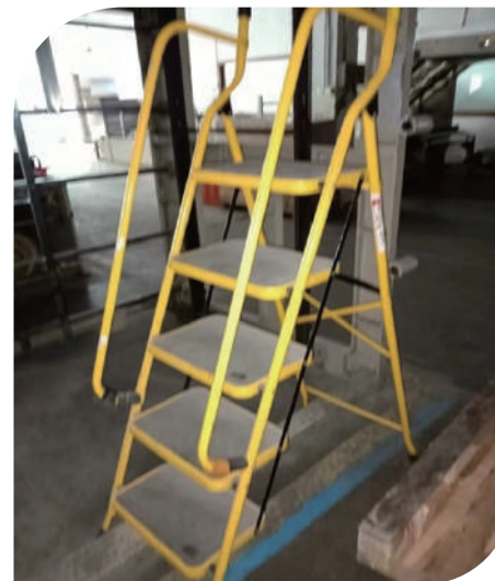
将原本有摔落风险的人字梯更换成双侧手扶梯
