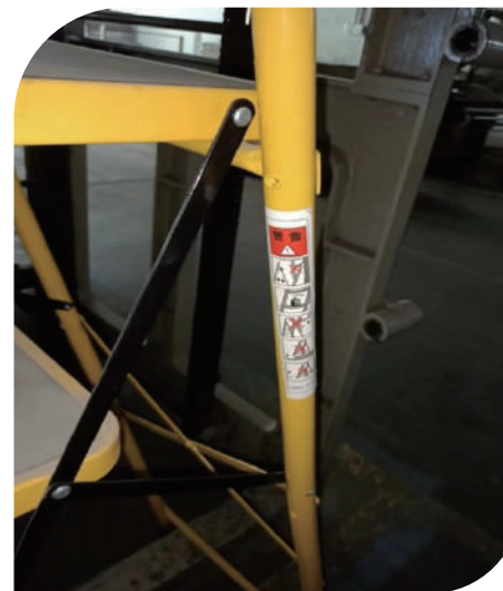
于手扶梯明显处张贴安全警告图示
